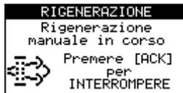
Tramite le segnalazioni nello strumento LAMPADE è possibile seguire lo stato della rigenerazione manuale.
