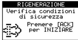
Viene richiesto all'operatore di avviare la procedura tramite la pressione del TASTO\_ACK per circa 3 secondi. A rigenerazione in atto è possibile interromperla premendo TASTO\_ACK per 3 secondi.
