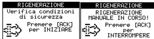
Tramite le segnalazioni nello strumento LAMPADE è possibile seguire lo stato della rigenerazione manuale.
