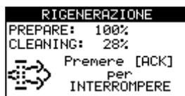
Tramite le segnalazioni nello strumento LAMPADE è possibile seguire lo stato della rigenerazione manuale.
