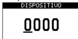
È necessario inserire una cifra alla volta, TASTO\_SX e TASTO\_DX per spostare il cursore, TASTO\_SU e TASTO\_GIU per cambiare la cifra. Per la verifica usare il TASTO\_ACK fino alla comparsa del risultato:
