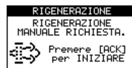
E' possibile interrompere la rigenerazione Stationary disattivando lo switch di stazionamento, spegnendo il motore, oppure escludendo la rigenerazione come nel caso della rigenerazione Reset.
