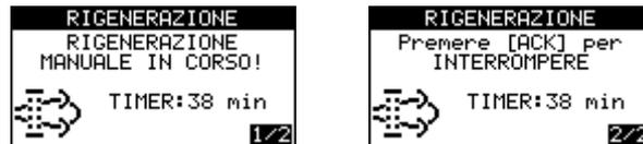
A través de las señalizaciones que se muestran en el instrumento PILOTOS, es posible controlar el estado de la regeneración manual.
