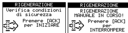
A través de las señalizaciones que se muestran en el instrumento PILOTOS es posible controlar el estado de la regeneración manual.
