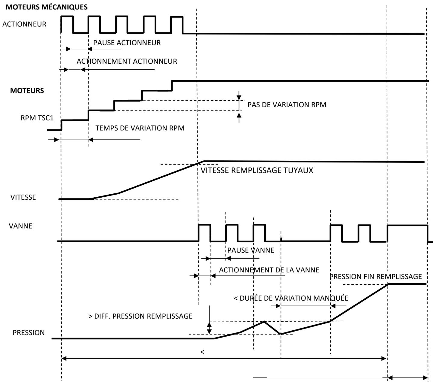
Sur les différents instruments, figure l'indication du remplissage des tuyaux :
