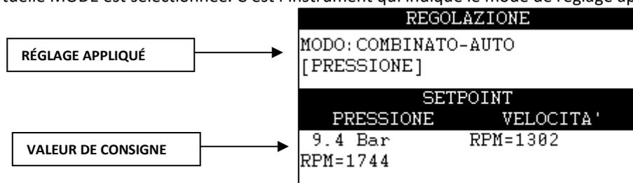
Sur l'exemple, est programmé le mode de réglage combiné avec auto-acquisition de la vitesse de consigne ; actuellement, le réglage de la pression est activé (conformément à la sélection sur les entrées) et les valeurs de consigne de pression (vitesse de travail comprise) et de vitesse sont indiquées. Dans le cas du mode Vitesse ou Pression (non combiné), une seule valeur de consigne est indiquée.
